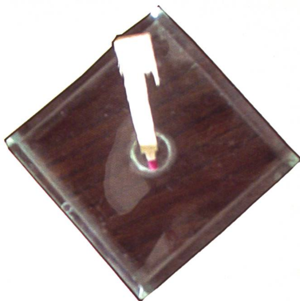
Mesure volumétrique pour « peser » la gelée royale. Conception M. W. Gonet. Photo RSA
