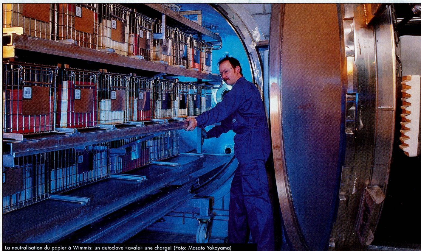
La neutralisation du papier à Wimmis: un autoclave «avale» une charge! (Foto: Masato Yokoyama)
