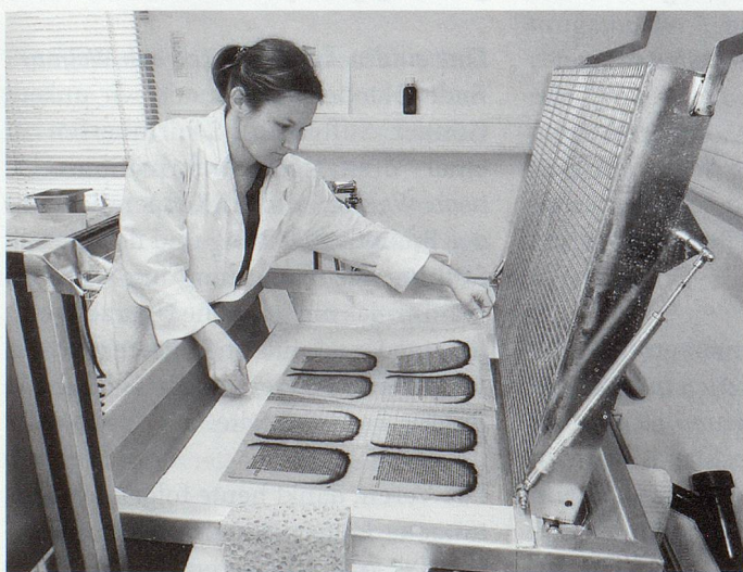
Im neuen Restaurierungsatelier in Ittigen bei Bern – Entnahme der angefaserten Buchseiten aus dem Anfasergeät.
