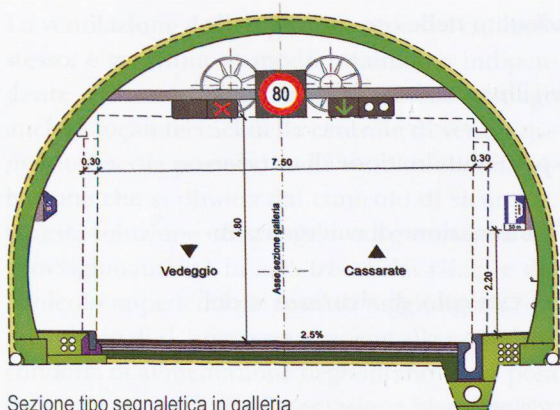
Sezione tipo segnaletica in galleria
