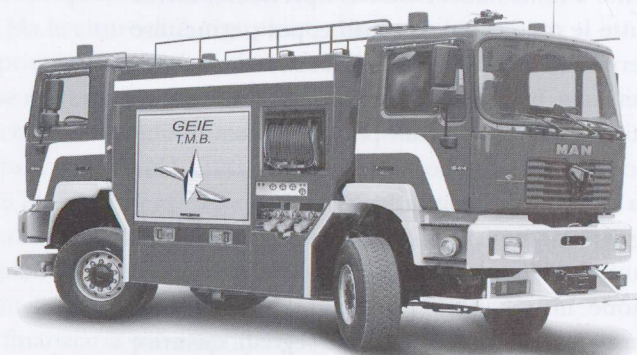
8 - Il maestoso Janus 4000, veicolo bifronte realizzato appositamente per il traforo del Monte Bianco
