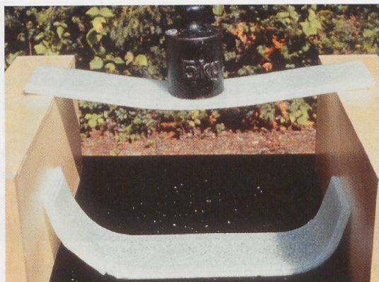
Fig. 2 – Capacità portante di pannelli in vetro stratificato completamente rotti. Mentre la lastra in primo piano è collassata, pochi secondi dopo tutte e due le lastre sono state distrutte volontariamente. Quella in secondo piano, pure completamente rotta, resiste ininterrottamente dal 1998 sempre con un carico di 5Kg.
