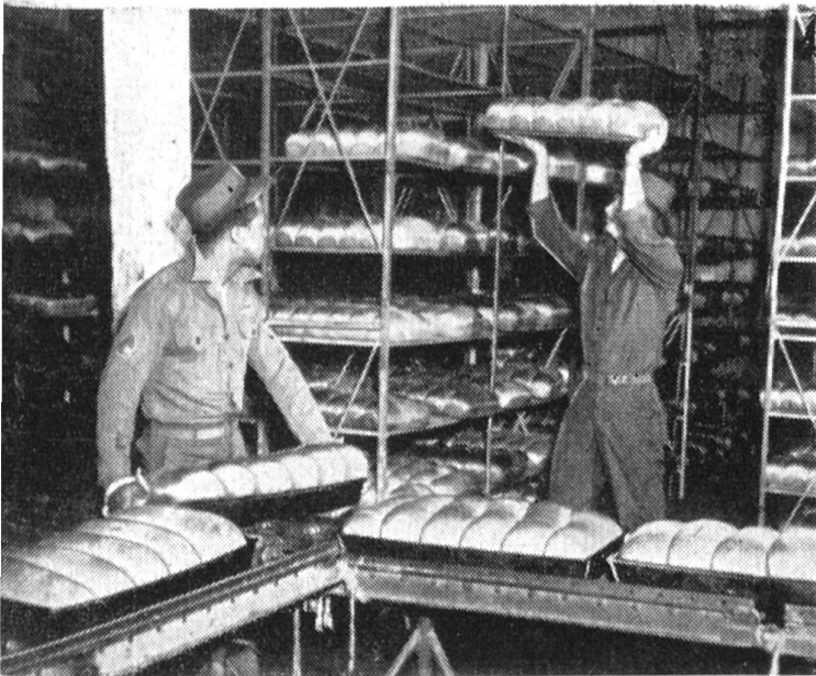
Verköhlen der Brote auf Drahtgestellen
