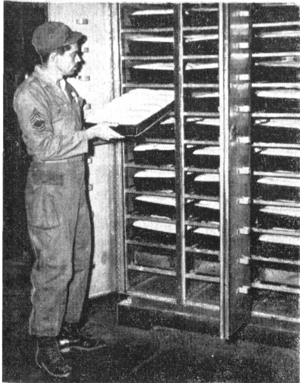
Einschieben der Formen mit Teigbroten in den Gärschrank
