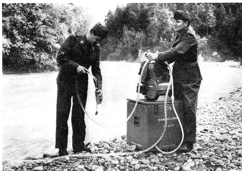
Mittleres Wasseraufbereitungsgerät (Leistung ca. 200 l / h)
