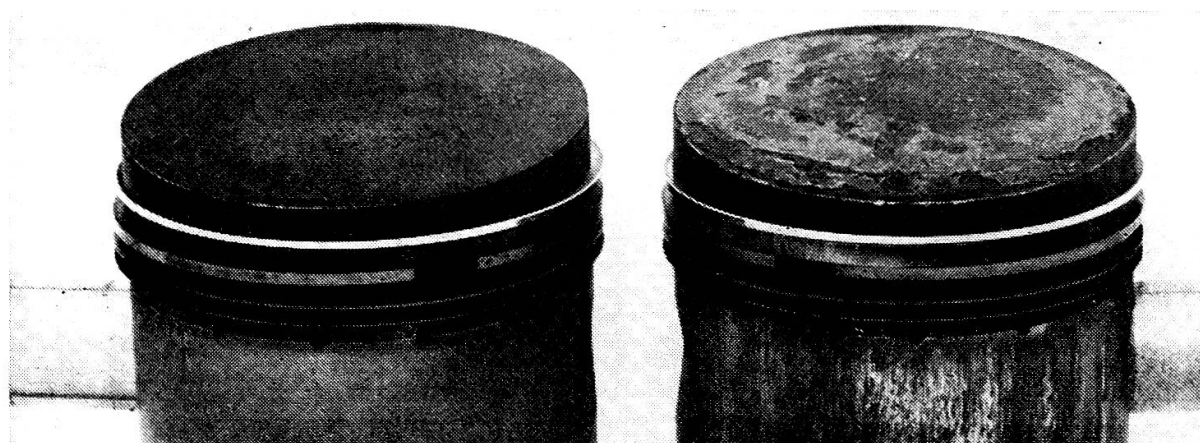
Auf diesem Bild ist deutlich erkennbar, dass der Kolben rechts als Folge ungenügender Tragfähigkeit des Schmierfilmes angefressen ist.
