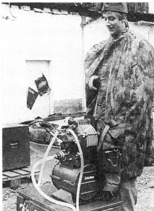
Trinkwasserfilter 70, Tornistergerät, 200 l pro Stunde
