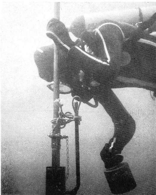
Abb. 49. Aufsetzen der Bodensonde.
