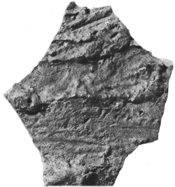
Abb. 6 Plattenschlacke wie solche bei der Gewinnung von Kupfererz entstehen. M. 1:1. Scorie aplatie, caractéristique de la réduction du minerai de cuivre. Scorie come si ottengono alla fusione di rame.
