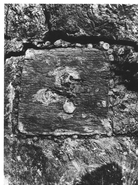
fig. 8 Planche du fond d'une barque. Pièce de remplacement carrée. Remarquer les trois grands clous centraux, le calfatage et les petits clous. Longueur d'un côté 14 cm. Quadratischer, genagelter Holzflick vom Bodenbrett einer Barke. Pezzo quadrato di sostituzione di una barca.
