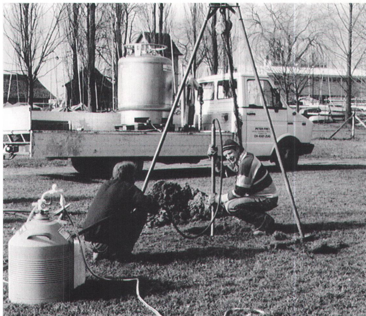
Abb. 3 Gefrierkern-Bohrung. Einrammen des Bohrrohres mit einem Presslufthammer. Das Kühlen des Rohres geschieht mit Flüssigstickstoff aus dem im Vordergrund sichtbaren mobilen Druckgefäss, das beim grossen Tank auf dem Fahrzeug jeweils wieder aufgefüllt werden kann. Foto S. Hochuli, Kantonsarchäologie Zug. Forage à basse température. Enfoncement du tube de forage à l'aide d'un marteau à air comprimé. »Trivellazione a carota congelata«. Introduzione della carota per mezzo di un martello pneumatico.
