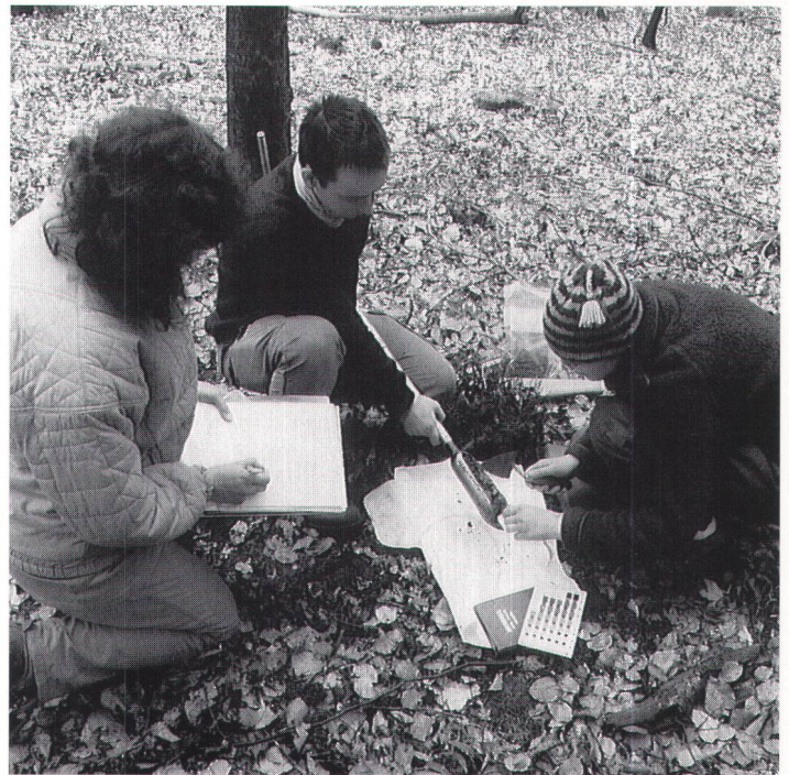
Abb. 5 Das Team beim Bohren. Jede Erdprobe wird gemäss eines eigens hierfür entwickelten Fragenkatalogs beschrieben und protokolliert festgehalten; die Farbbestimmung erfolgt mit dem Munsell Book of Colors Foto St. Schreyer, Kantonsarchäologie Zürich. L'équipe de prospection en cours de forage. Chaque carotte de terrain est décrite selon un protocole développé à cette fin; le Munsell Book of colors constitue la référence employée pour la détermination des couleurs. Trivellazioni. Ogni carota viene descritta e documentata sulla base di un formulario specialmente redatto per l'occasione; la denominazione dei colori avviene grazie al Munsell Book of Colors.
