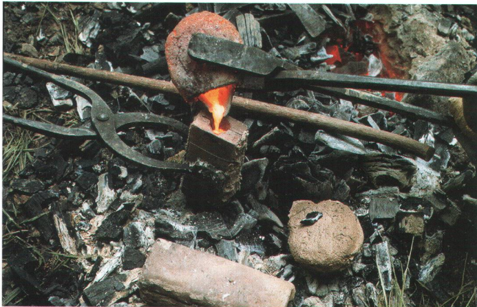
Abb. 2 Der keltische Münzguss im Experiment: Aus einem schiffchenförmigen Gusstiegel mit Tondeckel fliesst die flüssige Bronze in eine zweischalige Gussform aus ungebranntem Ton. Eisenzangen sind bereits im 4. Jh. v.Chr. belegt.
