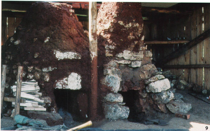
Fig. 8 Bas fourneau à double ventilation datant du début du Moyen Age, Boécourt-Les Boulies.
