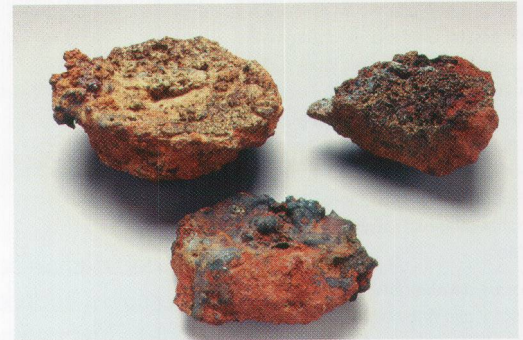
Scories coulées caractéristiques de la réduction du minerai de fer, provenant du bas fourneau, Chevenez-Lai Coiratte.
