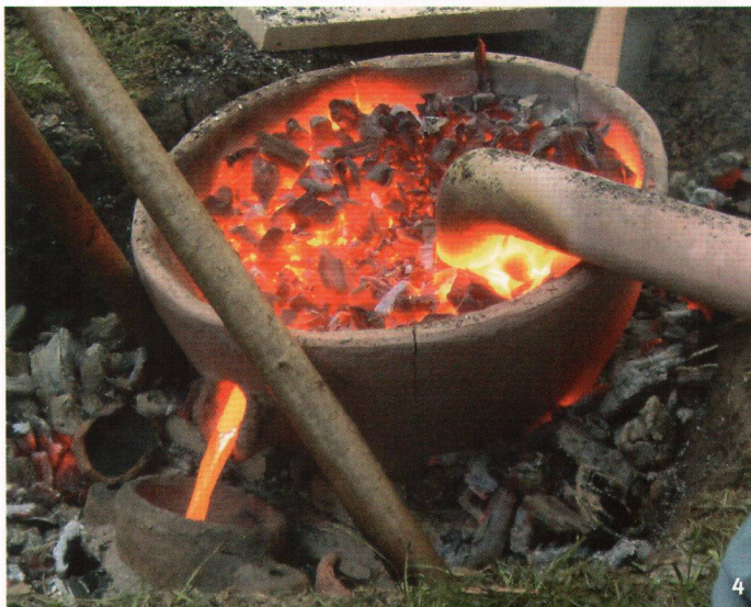
Abb. 3 Die Befeuerung des Tiegels erfolgt mit Holzkohle und Luftzufuhr über vier mit Blaskälgen betriebene Düsen.
