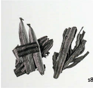
Fig. 18 Aiguilles de sapin blanc agglomérées pendant leur carbonisation.
