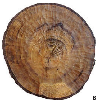
Fig. 8 Exemple typique de bois comprimé. Du côté amont du plan d'inclinaison, l'arbre a formé des cernes serrés, et par compensation des cernes plus larges du côté aval.
