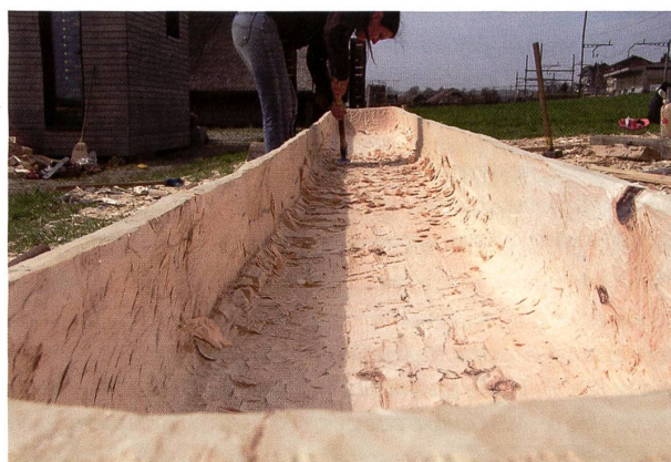
De la théorie à la pratique: évidage d'un tronc d'arbre pour la réalisation d'une pirogue.
