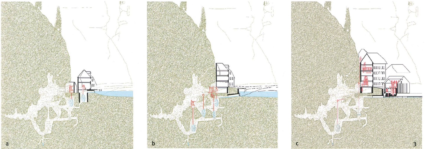
Fig. 2 Plan des vestiges. 1 Grotte, 2 Exutoire puis galerie de transmission, 3 Moulin de la Roche (1651), 4 Agrandissement du moulin (1856), 5 Moulin (1739), 6 «Citerne», 7 Moulin de la Citerne (1651), 8 Galerie de transmission (1856), 9 Digue et captage (1651), 10 Puit à pompe hydraulique (19 e s.), 11 Rural (18 e s.), 12 Fosses de scies à cadre (1856), 13 Scierie (1856), 14 Fosse de scie à déligner (1856), 15 Canal d'alimentation (1805), 16 Etang d'accumulation (17 e -18 e s.).
