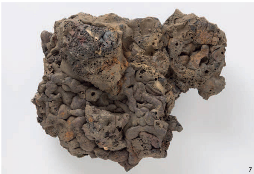
Abb. 7 Grau-dichte Flieβschlacken sind typisch für die frühmittelalterliche Eisenverhüttung in Büsserach.
