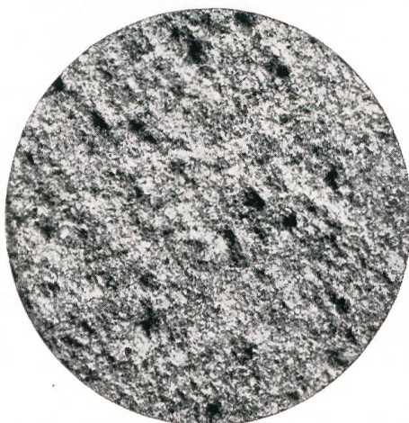
Mit dem Sandstrahlgebläse geprüfte Fläche von Gubersstein Naturgrösse
