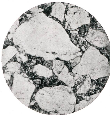
Dünnschliff von Gubersstein (hell = Quarzkörner, dunkel = Kalkkitt) 32 mal vergrössert
