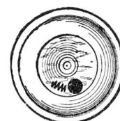
Abbildung 6 Ansicht eines Stöpselkopfes Patrone unversehrt Patrone durchgebrannt
