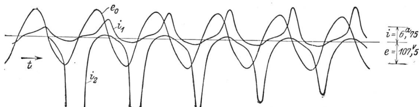
Abb. 6. Beide Transformatoren unbelastet. e_0 = Spannung. i_1 = eingeschalteter Transformator. i_2 = zugeschalteter Transformator. R = 0,04 Ohm.
