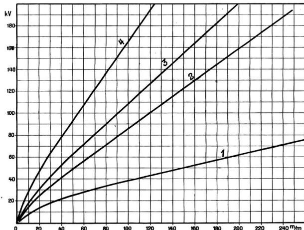
Fig. 19. Zulässige Minimalabstände zwischen den Spulen beider Schenkel.
