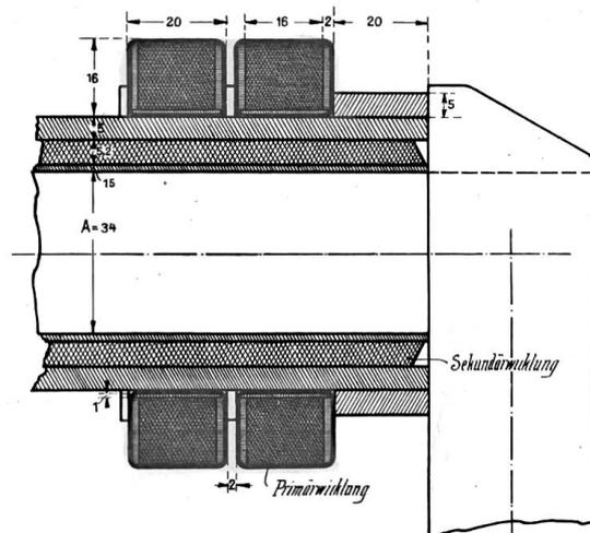
Fig. 20. Anordnung des Spulenkupfers und Isolation der Wicklungen.
