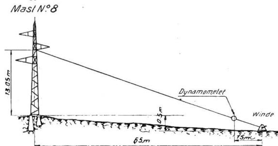
Bei 3000 kg. Zug am Dynamometer:
