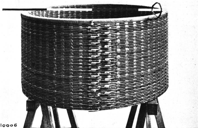
Fig. 7. Zum Einbau bereitete Spulenpaket der Mittelspannungswicklung. Gewicht ca. 700 kg. Aeusserer Durchmesser ca. 1600 mm.
