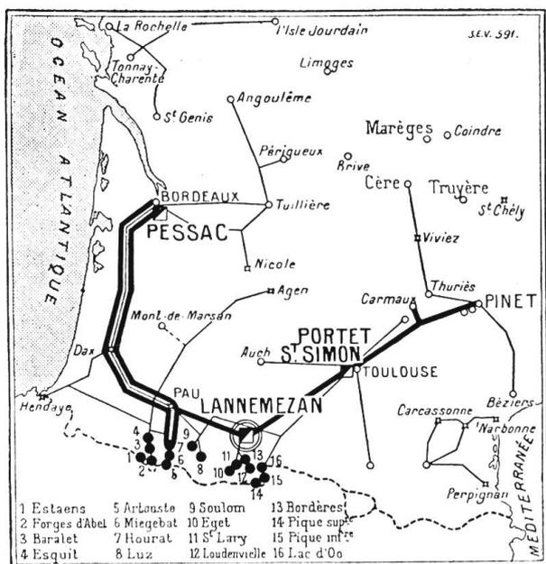
Elle a pour but d'obtenir la meilleure utilisation possible des usines hydroélectriques situées dans les Pyrénées, à l'ouest de la Garonne, en transportant, d'une part, l'énergie électrique dans les centres de consommation assez lointains, et, d'autre part, en faisant consommer les excédents sur place par des usines d'électrochimie ou d'électrometallurgie.
