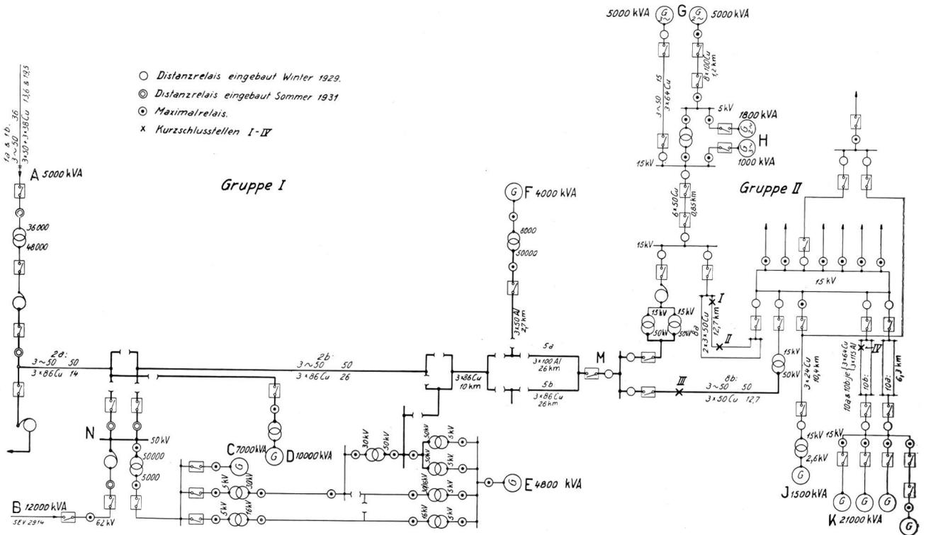
Fig. 1. Generelles Schema der Kraftwerksanlagen und Verbindungsleitungen.
