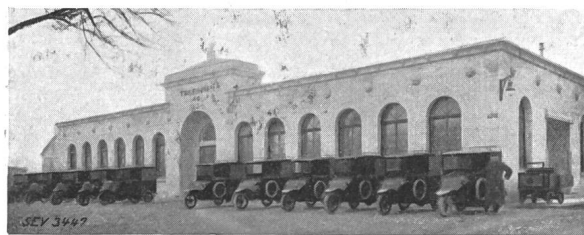
Fig. 1. Gruppe ablieferungsbereiter Dreiradwagen für die Postverwaltung (Paketbestelldienst). Ladegewicht 300 kg.
