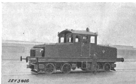
Fig. 4. Akkumulator-Verschiebe-Lokomotive mit Batterie von 110 kWh.
