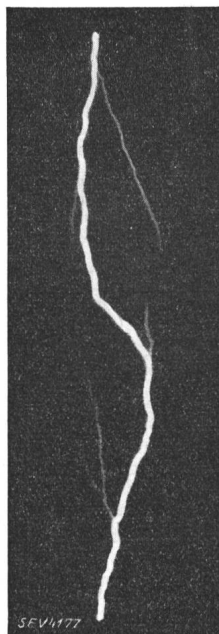
Fig. 7. Étincelle de choc entre électrodes à pointes, sous env. 3 millions de volts. (Laboratoire Ampère, Paris).
