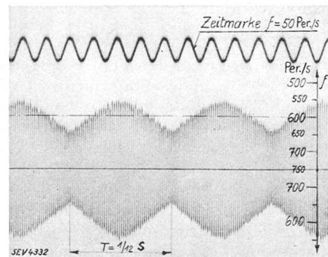
Fig. 8. Frequenzschwankung eines Heulton.  $f = 600 \pm 50$  Per./s.
