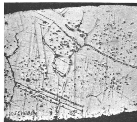
Fig. 6. Heizleiter-Längsschnitt mit Gefügeänderung, mässige Ueberhitzung.
