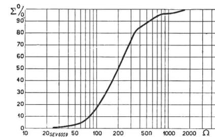
Fig. 2. Häufigkeitssummenkurve der Fahrdrahtimpedanzwerte im Frequenzbereich von 150 bis 1500 kHz.
