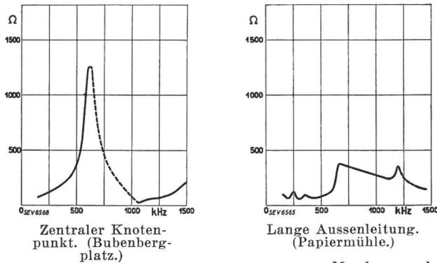
Fig. 1. Messkurven der Fahrdrahtimpedanz. — ohmisch-induktive Werte. ---- ohmisch-kapazitive Werte.
