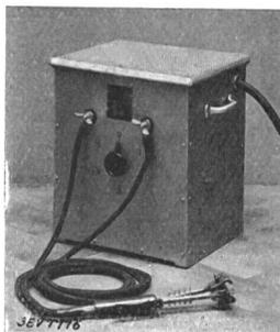
Description: Appareil selon figure pour la soudure électrique par bordage et bout à bout de minces tôles d'aluminium ou d'alliages d'aluminium. Transformateur à tension secondaire réglable (4 à 8 V). La soudure a lieu à l'aide d'électrodes de charbon que l'on guide le long des bords des tôles. Le passage du courant produit l'échauffement nécessaire des électrodes de soudure.
