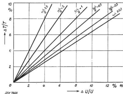
Fig. 4. Prozentuale Temperaturänderung ( $\Delta T/T$ ) als Funktion der Netzspannungsschwankung ( $\Delta U/U$ ) für verschiedene Werte des auf den Betriebswiderstand ( $R$ ) des Ofens bezogenen induktiven Widerstandes ( $\omega L$ ).
