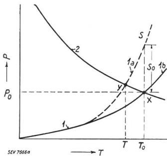
Fig. 5. Abhängigkeit der aufgenommenen Heizleistung (P) von der absoluten Ofentemperatur (T). Verschiebung des Arbeitspunktes (von X nach Y) bei zusätzlicher Strahlungskühlung  $S_0$ . 1 Ofenkennlinie, a bei geöffneter, b bei geschlossener Tür. 2 Heizleiterkennlinie.
