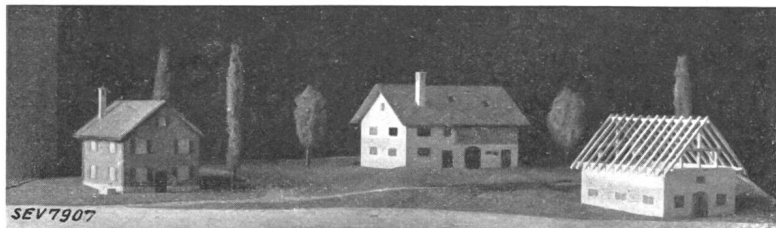
Fig. 10. Maquette d'un groupe de maisons servant aux démonstrations de la foudre dans le laboratoire à haute tension. Les éclairs sont produits par un générateur d'impulsions à 2 000 000 V.
