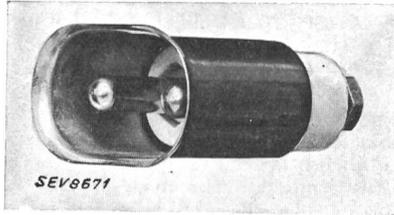
*Description:* Fiches d'appareils pour montage apparent, selon figure. Exécution 2P+T pour 10 A 250 V, selon norme SNV 24547. Collet protecteur et tiges de contact en laiton nickelé, isolations en stéatite.
