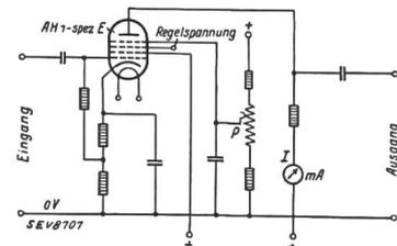
Fig. 5. Betriebsschaltung der Spezialröhre  $AH_1$  spez.  $E$ .
