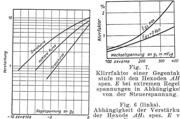
Fig. 6 (links). Abhängigkeit der Verstärkung der Hexode  $AH_1$  spez.  $E$  von der Regelspannung.
