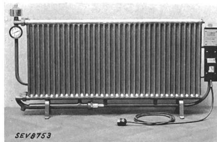
*Description:* Radiateur électrique selon figure. Deux éléments chauffants à remplissage d'eau, placés l'un derrière l'autre; constitués par deux tôles de fer ondulées. Tuyau de chauffe avec corps de chauffe électrique, placé au-dessous du radiateur. Dispositif de réglage de la température du radiateur placé sur le côté. Fiche d'appareil pour le raccordement du cordon d'alimentation.
