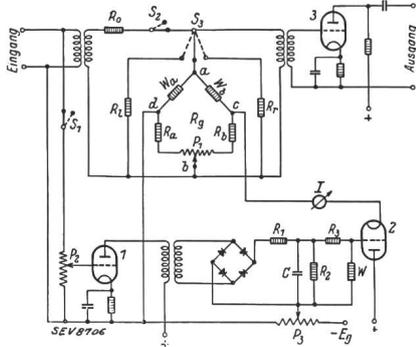
Fig. 4. Schaltung eines Dynamikpressers, der hohen Ansprüchen genügt, und bei dem die Regelung durch die nichtlinearen Widerstände  $W_a$ ,  $W_b$  erfolgt.
