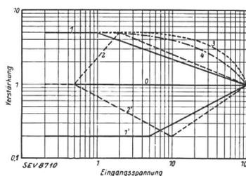
Fig. 8. Verstärkungsregelung: 1, 2 ideale Regelungen beim Dynamikregler; 1', 2' entsprechende Rückentzerrung im Dynamikdehner; 3 direkte Regelung mit  $AH_1$  spez.  $E$ ; 4 indirekte Regelung mit  $AH_1$  spez.  $E$  bei Voraussetzung ideal geregelter Ausgangsspannung.
