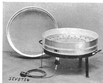
*Description:* Séchoir électrique en tôle d'aluminium selon figure. Résistance de chauffe placée dans la partie inférieure de l'appareil. Quatre récipients destinés à contenir les matières à sécher de 520 mm de diamètre. Raccordement au réseau par cordon rond à 3 conducteurs, muni d'une
