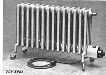
*Description:* Radiateur électrique selon figure. Le radiateur comprenant 14 éléments est rempli d'un liquide. Les corps de chauffe sont montés dans la partie inférieure. Un interrupteur de réglage permet de faire fonctionner le radiateur à pleine ou demi charge. Raccordement au réseau au moyen d'un cordon à gaine de caoutchouc à 3 conducteurs muni d'une fiche.
