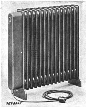
*Description:* Radiateur électrique selon figure. Radiateur en acier rempli d'huile; corps de chauffe logé dans la partie inférieure du radiateur; régulateur de température, placé dans la partie supérieure. Raccordement au réseau au moyen d'un cordon à gaine de caoutchouc à trois conducteurs, muni d'une fiche.
