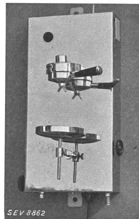
Description: Percolateur pour montage mural selon figure, fonctionnant comme chauffe-eau instantané. L'eau circulant à l'intérieur de l'appareil est en contact direct avec la résistance de chauffe. Le robinet d'eau est couplé avec un interrupteur bipolaire, ce qui évite que l'appareil soit chauffé lorsque le robinet est fermé. Raccordement au réseau au moyen d'un cordon à gaine de caoutchouc à 3 conducteurs muni d'une fiche (2 P + T).
