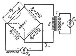
Fig. 3. Schaltung für Wechselstromüberlagerung (Brücke).
