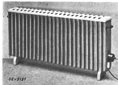
Description: Radiateur électrique selon figure. Le corps de chauffe, constitué par du fil résistant enroulé en boudin et fixé sur une plaque d'éternite, est monté dans la partie inférieure d'un bâti en tôle non ventilé, muni d'ailettes. Un interrupteur de réglage permet de faire fonctionner le ra-
