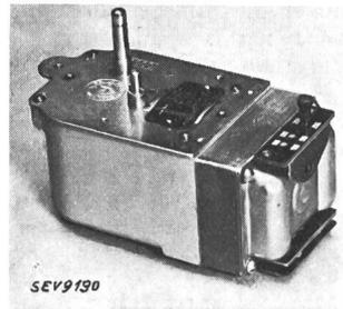
Description: Moteur de gramophone selon figure, pour montage dans des appareils. Moteur monophasé à induit en court-circuit, démarrant automatiquement, avec régulateur et réducteur de vitesse pour régler la vitesse des disques de 70 à 90 tours/mi-nute. L'enroulement statatoire, avec prises intermédiaires, est commutable
