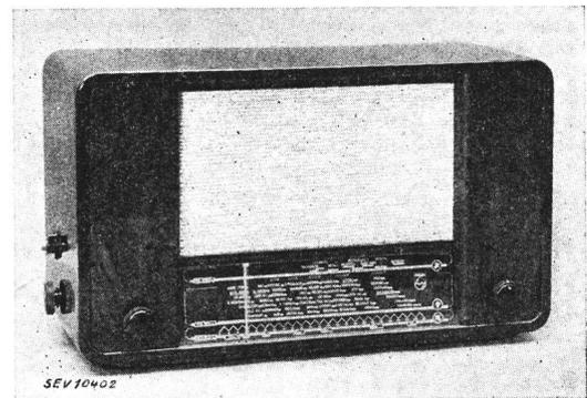
**Beschreibung:** Kombiniertes Radio- und Telephonrundsprachapparat gemäss Abbildung. Apparat für den Empfang langer, mittlerer und kurzer Wellen, ferner für niederfrequenten Telephonrundsprach und Grammophonverstärkung. Lautstärkereger, Tonblende und Programmwähltaste. Anschluss eines zweiten Lautsprechers möglich.
