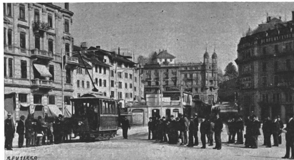
Fig. 6. Voiture motrice des Tramways électriques zurichois, à la Place Bellevue, en 1894 (Courant continu 500 V)
