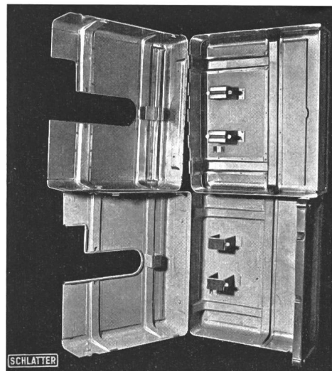
Fig. 19. Nähmaschinenkasten mit ca. 250 Punktschweissungen
