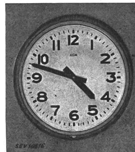
**Description:** Horloge murale selon figure, avec boîtier métallique ayant 300 mm de diamètre. Mouvement avec balancier, échappement et réserve de marche. Remontage par un moteur Ferraris enclenché en permanence. Le raccordement du cordon d'alimentation s'effectue au moyen d'un serre-fils fixé à un conducteur de courte longueur.
