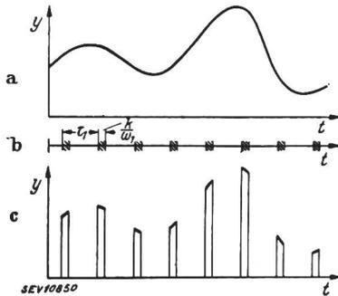
Fig. 1. Die Sendefunktion (a) wird durch einen Verteiler (b) in die Empfangsfunktion (c) verwandelt
