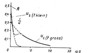
Angenähert berechnete übertragene Spannung  $u_2$  bei der  $\Delta$  Schaltung. SEV 12213
