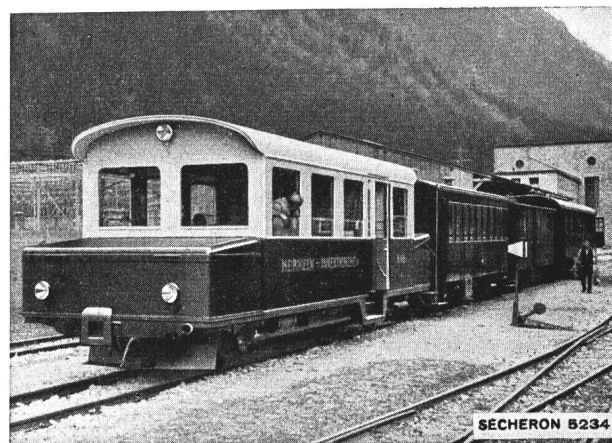
Fig. 1. Secheron-Akkumulatoren-Triebwagen der Kraftwerke Oberhasli 1) mit Traktionsbatterie Leclanché
