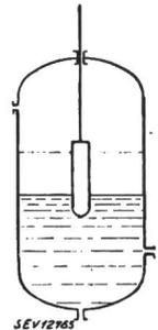
Die Wärmeerzeugung durch Hochfrequenz gelangt auch bei der Oberflächenhärtung von Stahl zur Anwendung. Als hervorstechendste Merkmale der Induktionsheizung im allgemeinen können genannt werden: Geringe Uebertemperatur des Wärmeerzeugers gegenüber dem Schmelzgut. Aeusserst intensive Baddurchmischung, die selbständig erfolgt. Anschluss nur an Wechselstrom möglich. Höchste Anschlusswerte für gegebene Heizflächen.
